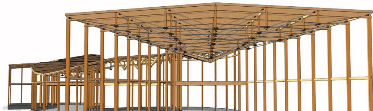
ブレース接続（ATAトラス・パース図）
