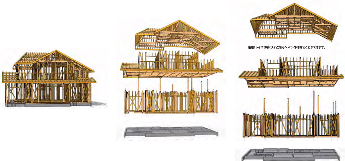
各階層のレイヤごとにX・Y・Zの軸方向に分割して表示することができるスライドパス
