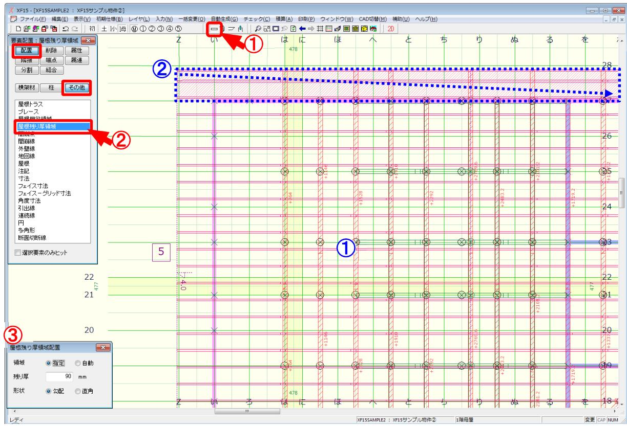
配置／屋根残り厚領域では、屋根レイヤで領域を指定し残り厚の生成範囲を配置します。
