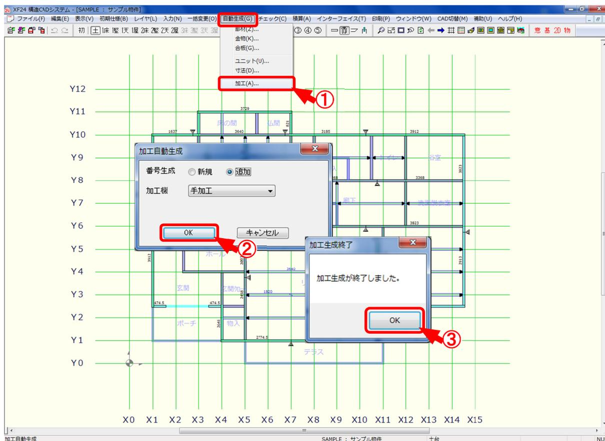
自動生成／加工では、材の端部、長さ、形状を決定します。
