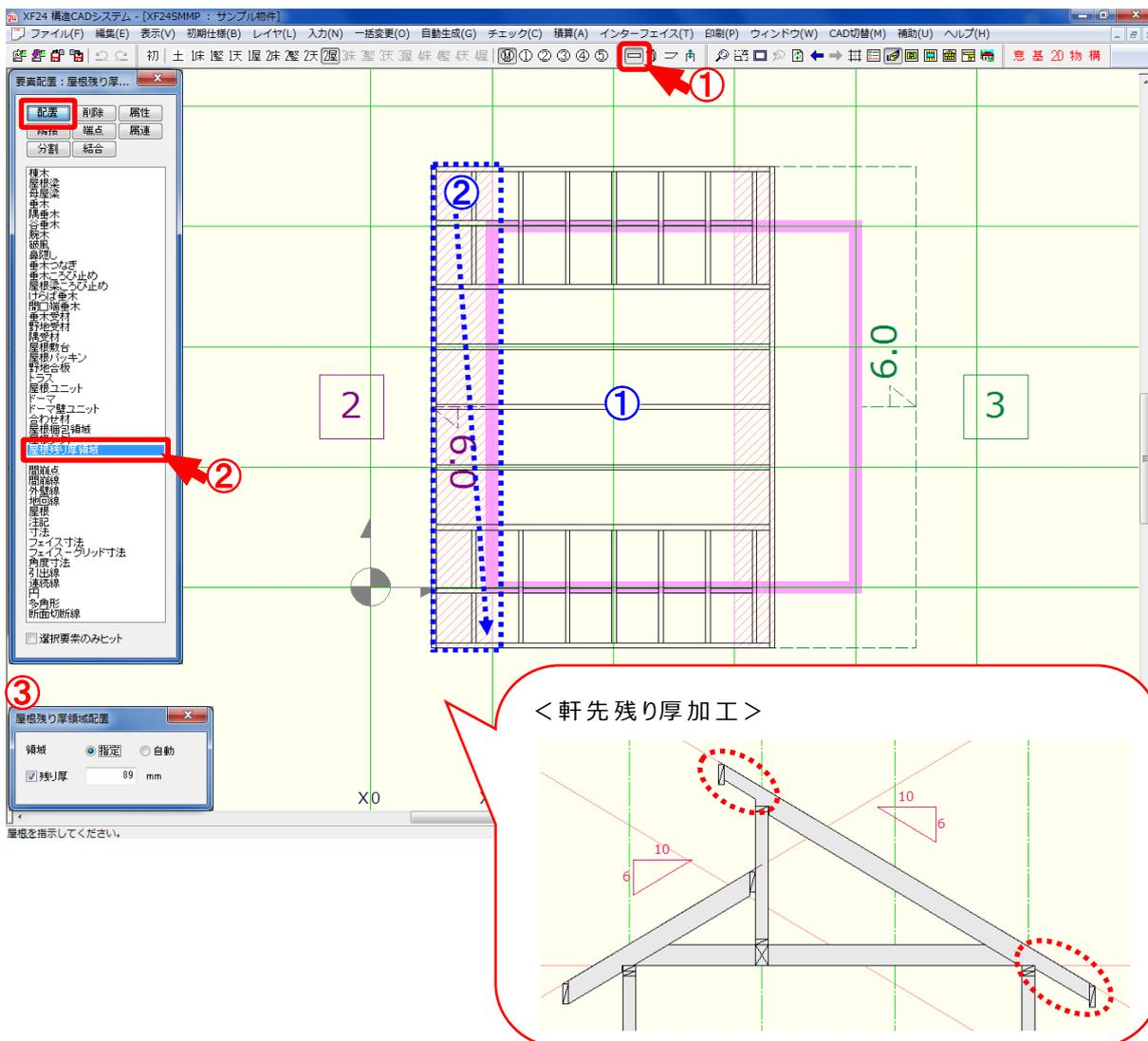
配置／屋根残り厚領域では、屋根レイヤで領域を指定し軒先残り厚の生成範囲を配置します。
