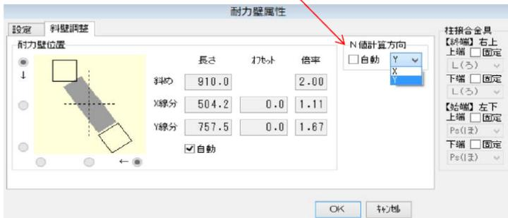
N値計算の方向については、耐力壁の倍率が大きい方に自動判定をしていますが手動に変更することもできます。
