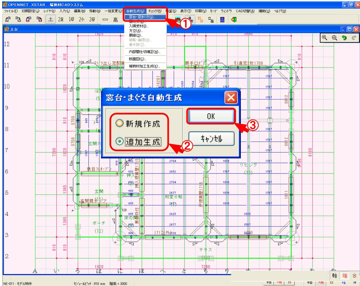
窓台／窓まぐさでは、配置された開口部に窓台・窓まぐさを生成します。
