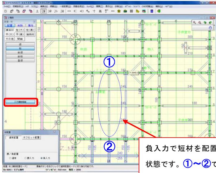
負入力で短材を配置した状態です。①～②で材を配置します。
