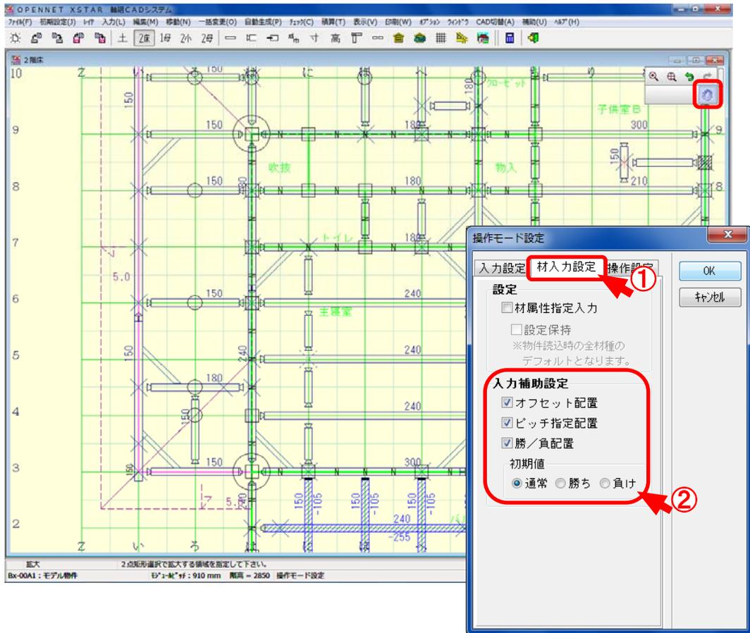
土台、大引き、桁・梁の配置時に「オフセット配置」、「ピッチ配置」、「勝/負配置」ができるようになりました。
