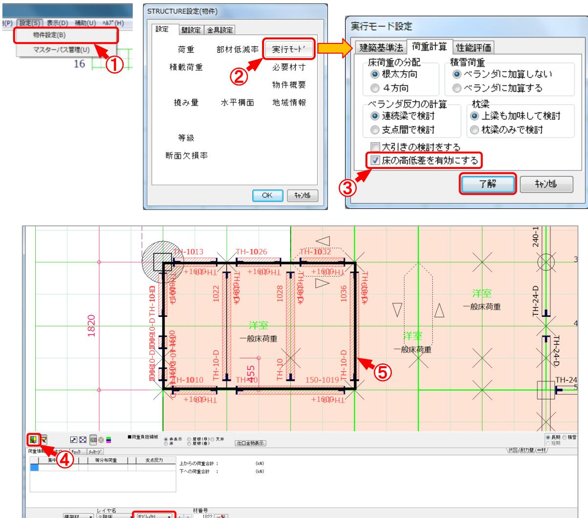
床荷重の高低差を指定して、サブレイヤに配置した材に等分布荷重をかけて計算できるようにしました。サブレイヤに配置した同じレベルの材に、床と天井の等分布荷重を考慮して荷重計算を行うことが可能です。
