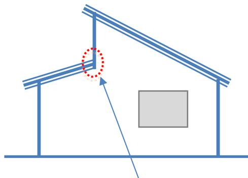
片流れの屋根が段違いで配置されている場合、壁に当たる屋根側を屋根線から自動で判断して、壁厚を引きます。
