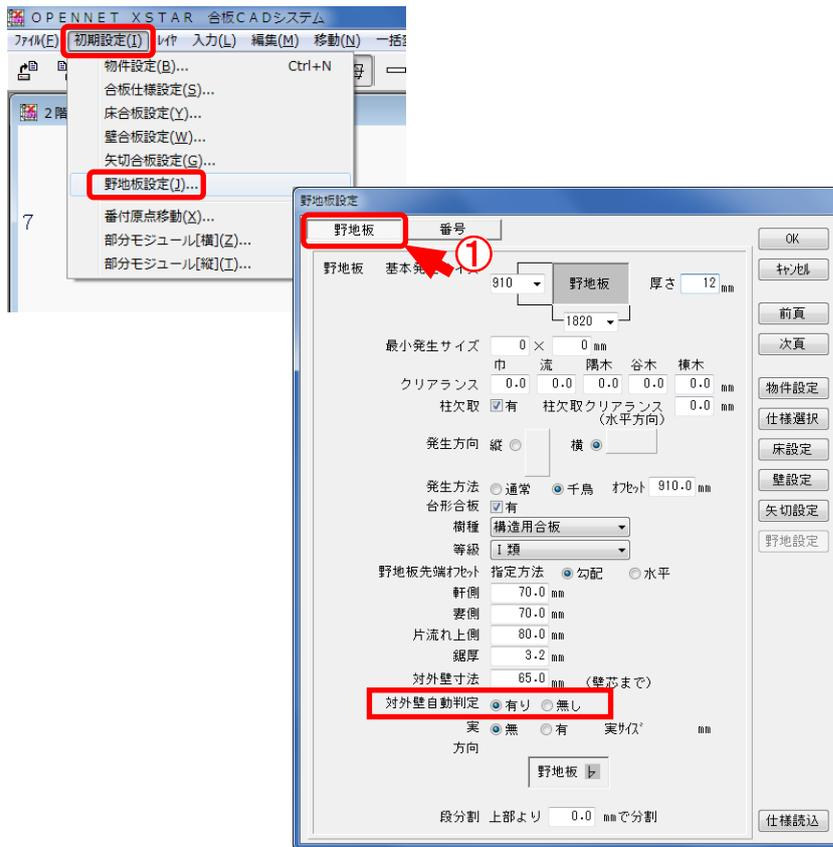
対外壁自動判定では、屋根線によって外壁寸法を自動で判断します。
