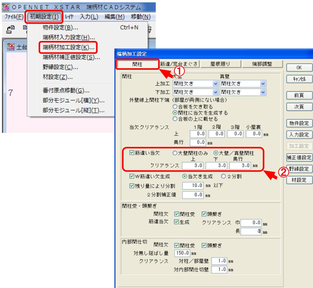
間柱の筋違い当欠きでは、上・下・奥行のクリアランス設定ができます。
