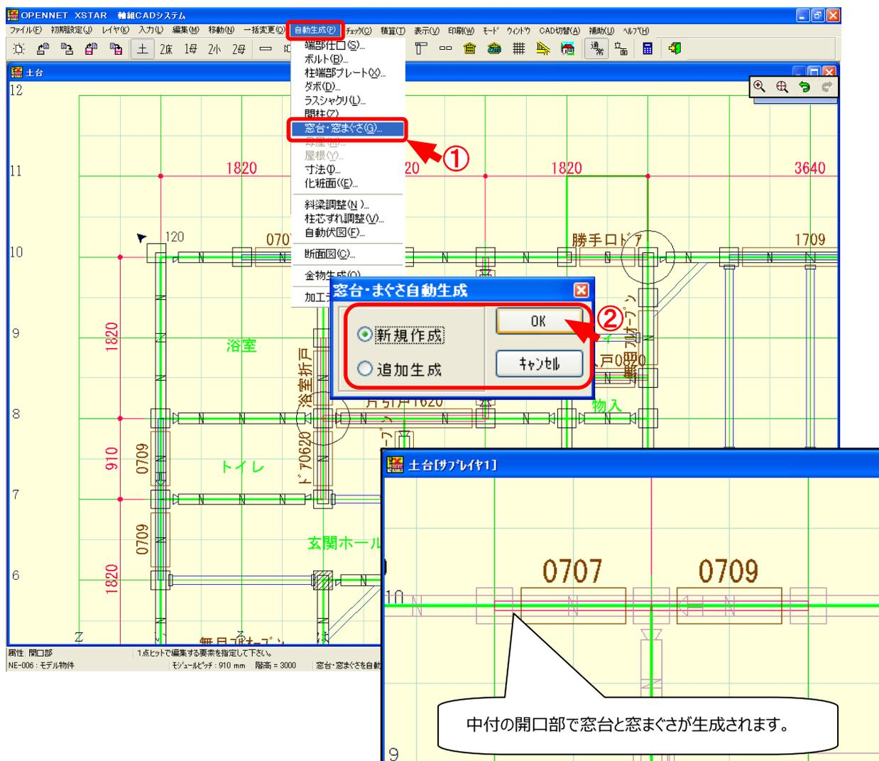
窓台／窓まぐさでは、配置した開口部に窓台・窓まぐさを自動生成します。
