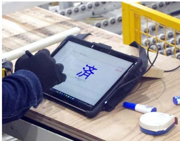
検品時はPNPSに表示される加工図へタッチペン入力で確認箇所をチェックし「済」ボタンを押下
