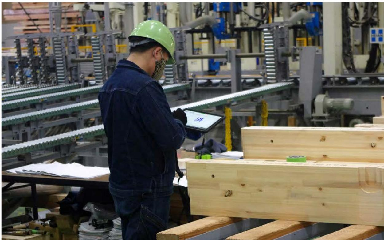
加工した製品の検品はタブレット画面に表示されるPNPSの加工図を参照しながら行う
