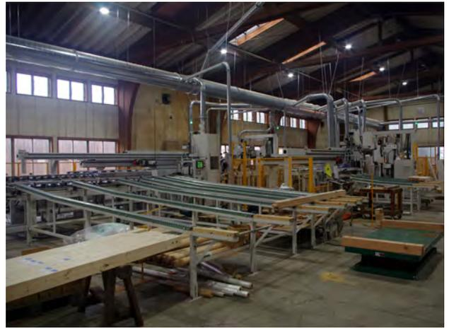
PNPSとデータ連携している平安コーポレーション製の横架材加工機（写真左）と柱材加工機（写真右）
