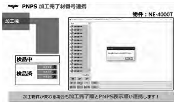
プレカット加工機（平安コーポレーション製）との連動による加工完了材番号の連携
