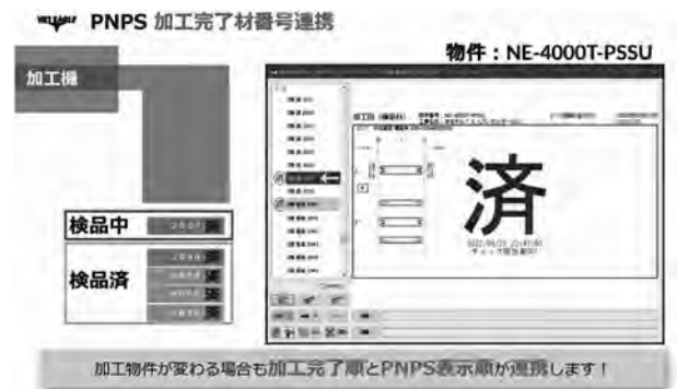
プレカット加工機（平安コーポレーション製）との連動による加工完了材番号の連携
